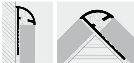
1: Scegliere il "PROJOLLY" di altezza corrispondente allo spessore del rivestimento. 2: Applicare il collante nella zona di applicazione del profilo. 3: Appoggiare e allineare il profilo, tagliato alla lunghezza necessaria, premendo l'aletta traforata nel collante. 4: Posare le piastrelle allineandole in modo che la parte superiore del profilo chiuda a "filo". 5: Riempire completamente di collante l'area di contatto tra profilo e piastrella per evitare l'accumulo di acqua negli spazi vuoti.
