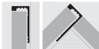
1: Scegliere il "PROTERMINAL" di altezza corrispondente allo spessore del rivestimento. 2: Applicare il collante nella zona di applicazione del profilo. 3: Appoggiare e allineare il profilo, tagliato alla lunghezza necessaria premendo l'etichetta trattata nel collante. 4: Posa le piastrelle allineandole in modo che la parte superiore del profilo chiuda a "filo". 5: Riempire completamente di collante l'area di contatto tra profilo e piastrella per evitare l'accumulo di acqua negli spazi vuoti.
