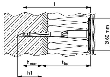
$t_{fix}$  = spessore di isolamento + colla + intonaco esistente
