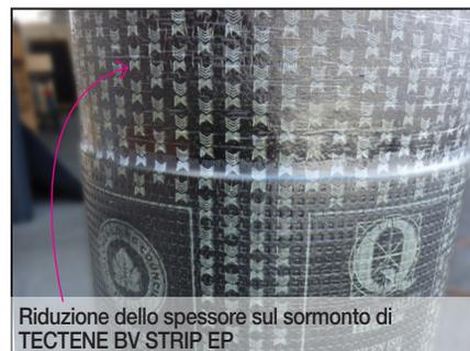
zona di sormonto, prodotta con uno spessore ridotto rispetto al resto del foglio, tale che, una volta eseguita la sovrapposizione, lo spessore totale della stessa non supera quello delle strisce adesive, evitando così "l'effetto altalena" dei pannelli isolanti che vi sono posti a cavallo.
