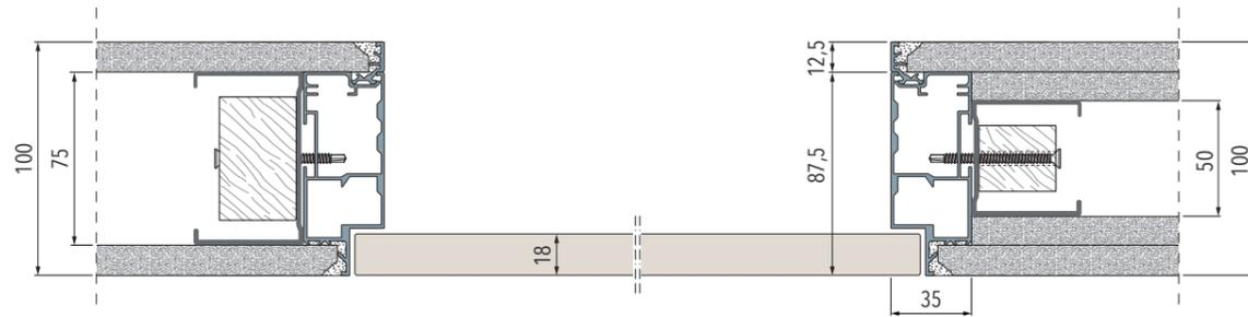
Telaio su parete in cartongesso con 1 o 2 lastre con spalletta interna
