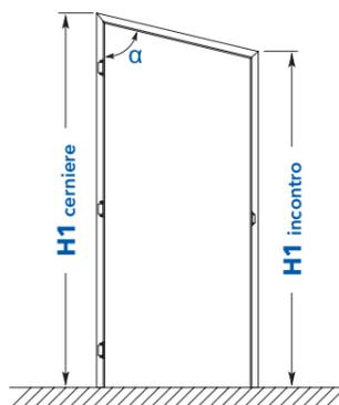
telaio battente per un'anta con o senza traverso  $\alpha$  da 60° a 89°
