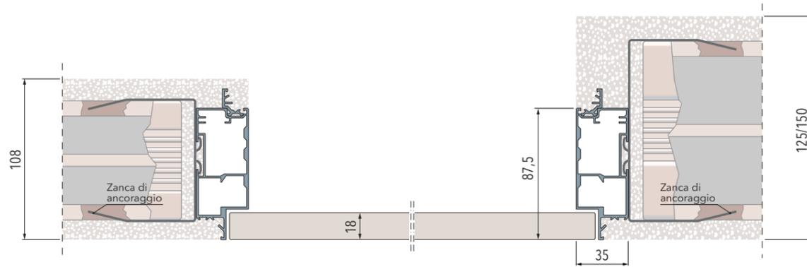
Telaio su parete in cartongesso con 1 o 2 lastre - Spessore parete finita 100 mm
