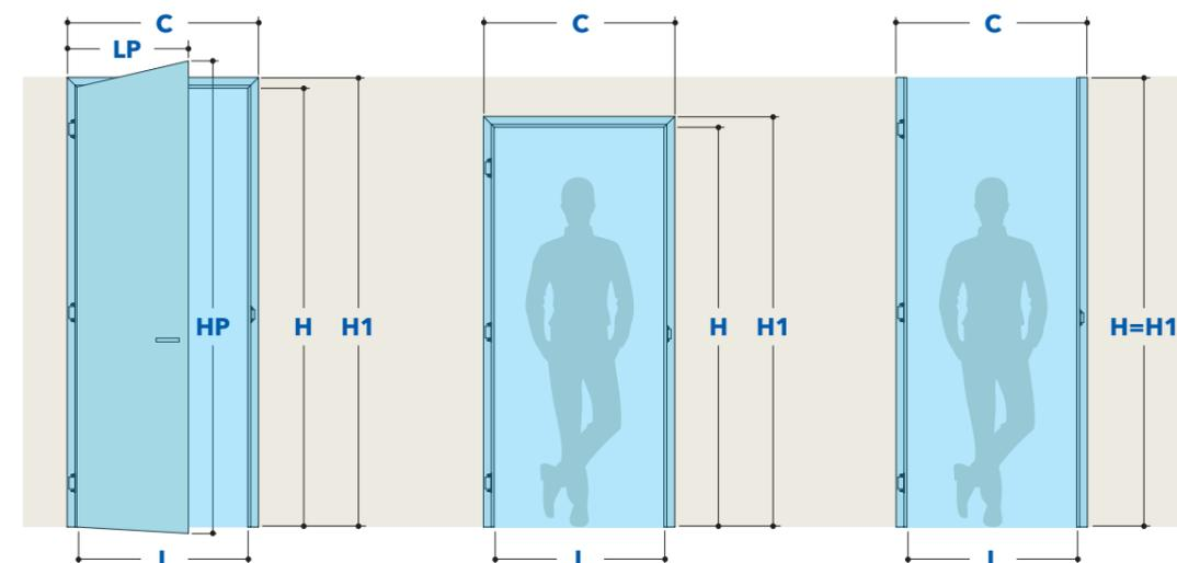
Il telaio per anta singola può essere realizzato con la parte superiore inclinata, per pareti in muratura e in cartongesso, nelle versioni con traverso e senza traverso.
