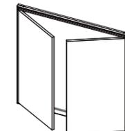
**ANTA DOPPIA** - Passaggio utile tra cerniere e serratura circa **150 mm** in meno rispetto alla luce di passaggio
