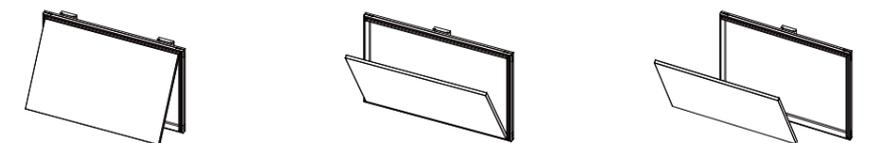
**ANTA A RIBALTA** - Passaggio utile tra cerniere e serratura circa **100 mm** in meno rispetto alla luce di passaggio
