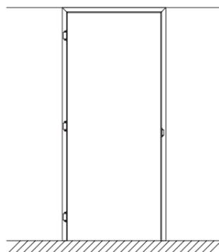
telaio battente per un'anta senza traverso
