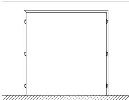
telaio battente per due ante con traverso
