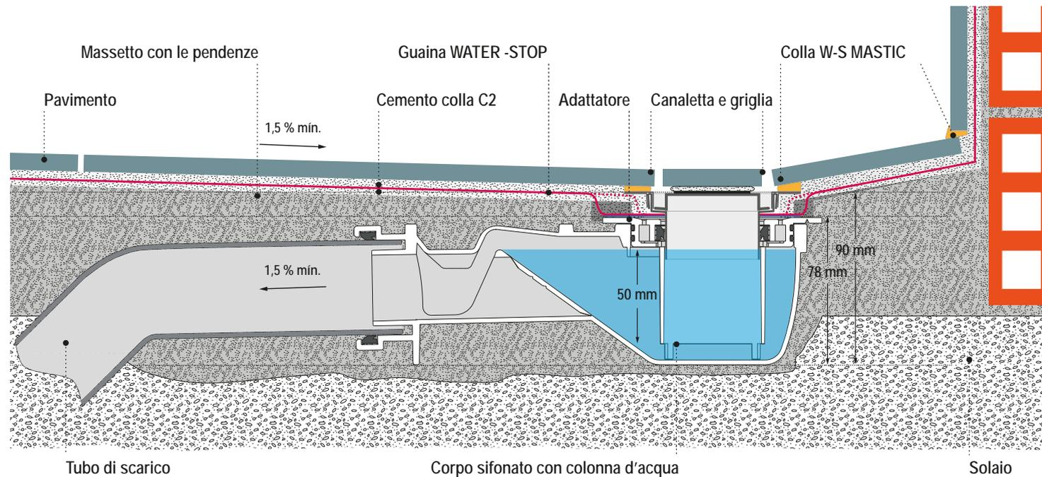
Altezza totale dell'installazione nella parte piú alta della griglia di 100 mm con spessore del pavimento di 10 mm.
