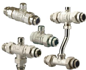
Le valvole di zona motorizzate VZS vengono utilizzate per intercettare il fluido all'interno degli impianti di riscaldamento/condizionamento o di distribuzione di acqua sanitaria. L'intercettazione può avvenire per chiusura o per deviazione. Le valvole di zona VZS hanno un funzionamento di tipo ON/OFF. Essendo a sfera a passaggio totale, sono caratterizzate da basse perdite di carico anche a portate elevate. Sono disponibili nelle varianti a 2 vie, con o senza by-pass, oppure a 3 vie.
