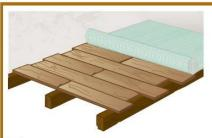
1 Mettere a nudo l'assito/pianelle in cotto e stendere Membrana CentroStorico (o equivalente telo di materiale impermeabile e traspirante) avendo cura di sovrapporre i teli di ca. 10 cm.
