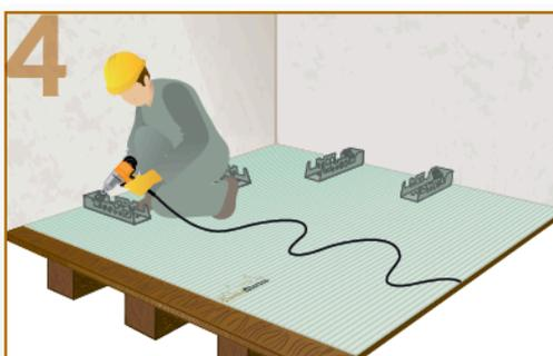
4 Attendere l'indurimento di Ancorante Chimico (in funzione della temperatura da ca. 5 h, +5°C, a ca. 40 min, +30°C) e procedere al saggio del Tirante-Spinotto al Prisma di base a mezzo avvitatore con bussola da 19 mm.
