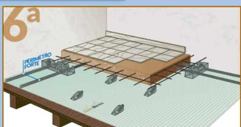
6a Completare il sistema con la posa di Connettore CentroStorico Legno/Acciaio/Calcestruzzo/Chimico, la rete elettrosaldata (legata al Connettore sfruttando le apposite sedi previste nel Prisma) e il getto di Calcestruzzo Leca per la formazione della soletta collaborante oltre all'eventuale strato di finitura in massetto leggero Leca.
