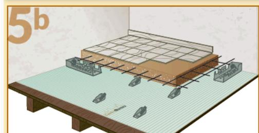
5b Completare il sistema con la posa del Connettore CentroStorico Legno/Acciaio/Calcestruzzo/Chimico, la rete elettrosaldata (legata al Connettore sfruttando le apposite sedi previste nel Prisma) e il getto di Calcestruzzo Leca per la formazione della soletta collaborante oltre all'eventuale strato di finitura in massetto leggero Leca.
