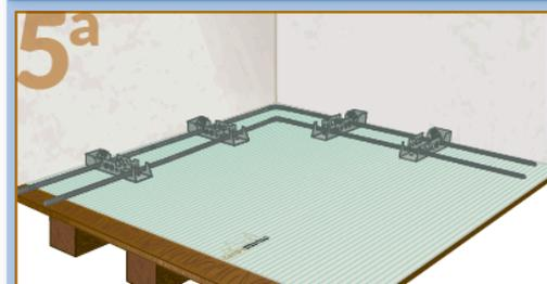
5a Posare le barre d'armatura longitudinali (si consiglia  $\phi$  12 o 14 o 16 mm) all'interno delle sedi previste nel Prisma di base così da realizzare la cerchiatura antisismica perimetrale (si suggerisce, negli angoli, di impiegare barre già piegate a misura).
